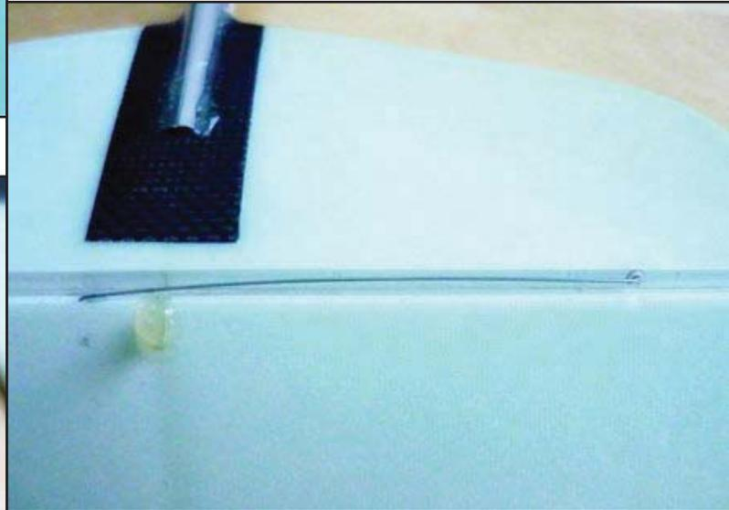
**Tipp fünfzehn:** Die typische Feder in einem Seitenleitwerk aus Schaum. Hier den Draht bitte nicht einfach in den Schaum schieben, das arbeitet sich mit der Zeit durch den Druck nach außen durch. Erst kleine Stücke eines Teflonröhrchens in den Schaum setzen, dann die Feder hinterher. So klappt das besser!
