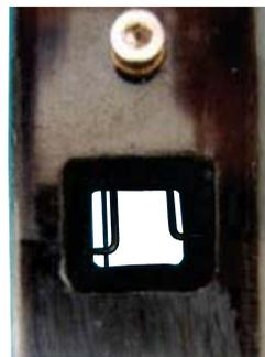
Typisch »Fireworks«: Daran erkennen Sie die DLGs von PCM – die Anlenkung der Querruder mit langen Kohlestangen aus dem Rumpf heraus. Ist mit etwas Übung nicht halb so frickelig, wie es aussieht
