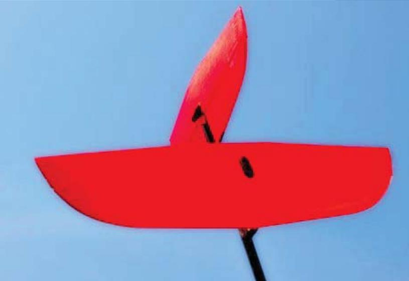
**Flugstabil:** das Leitwerk aus leichtem, zwei Millimeter „dickem“ Balsa. Angelenkt durch den typischen Anglerfaden, dagegen hält eine 0,3-mm-Feder aus Stahl draht. Bitte nicht dicker, das verbiegt das Leitwerk wie eine Banane
