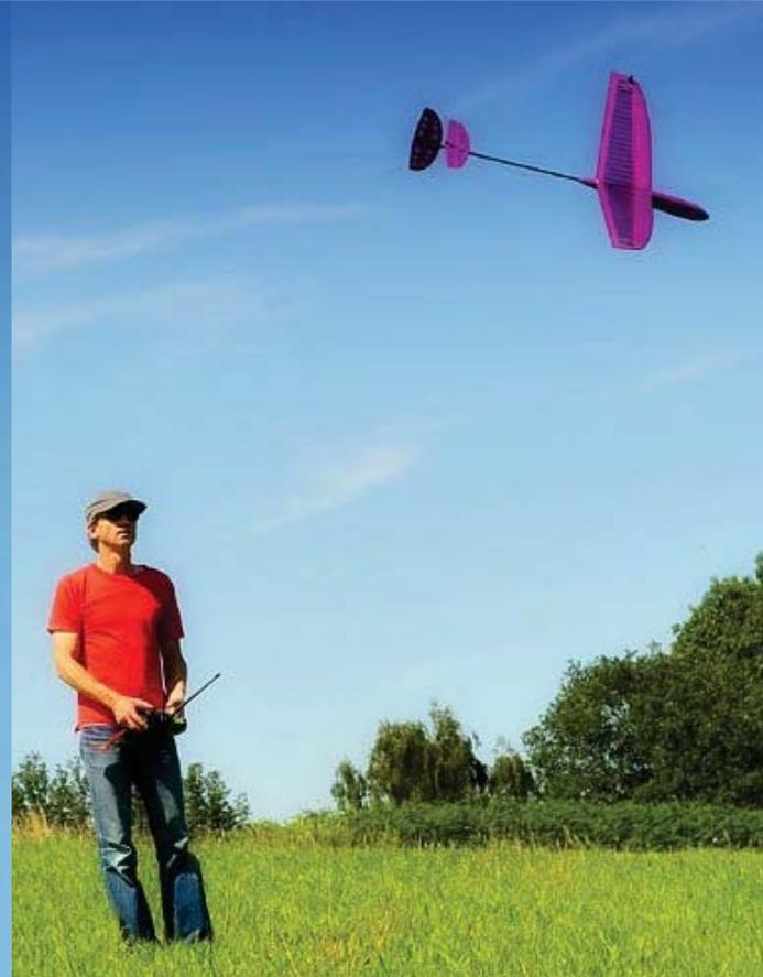
**Schwachwind-Genießer:** In der Ebene mag der »Birdy« keine Windstärken über drei bis vier. Dann gehen Sie bitte an den Hang. Bei guter Luft und schwachem Wind können Sie Thermik in Augenhöhe auskreisen – minutenlang
