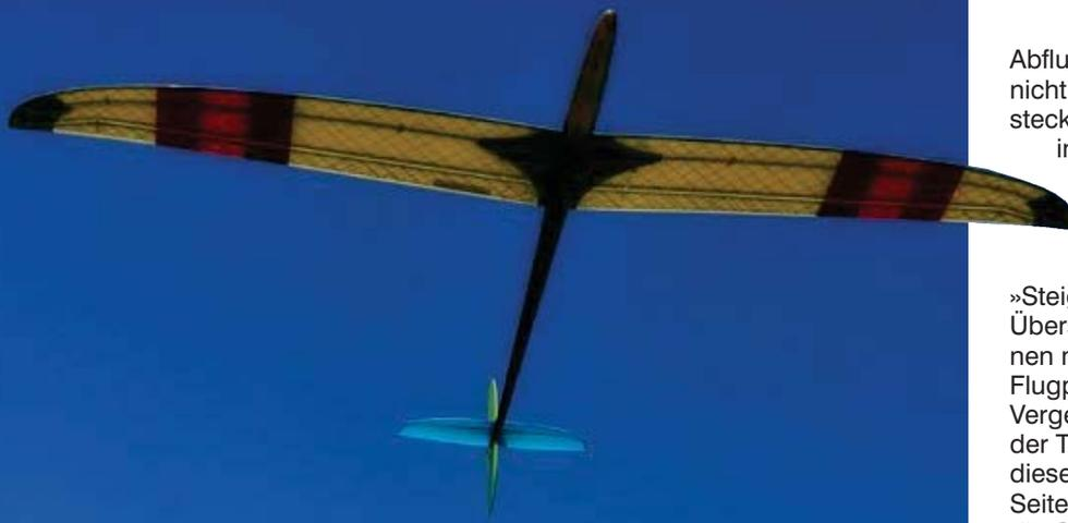
Abfluggewicht von 299 Gramm. Wem das noch nicht schwer genug ist (gut, im »Steigeisen« steckt jede Menge Luxus, in diesem Testmodell insgesamt für 940 Euro und 30 Cent – und so was wiegt natürlich), der kann optional bis zu 70 Gramm mit Messingrohren aufballastieren.
