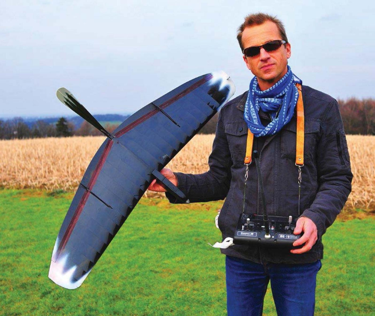
Tief und schnell: Egal, ob in der Ebene oder am Hang, der »DLG-Bird« reagiert extrem direkt auf die Ruder. Wer gerne flott an den Knüppeln rührt, wird mit diesem fliegenden Meter in der Luft sein Vergnügen haben. Machen Sie den Nurflügel zu langsam, sackt er böse durch. Das wollen Sie nicht, schon gar nicht in Bodennähe
