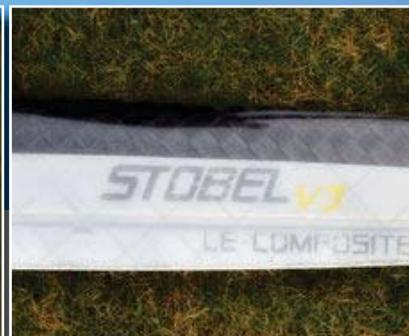
**Streck dich:** Hier sehr schön zu sehen, die etwas höhere Streckung des »Stobel V3«. Dissergewebe mit einer D-Box aus Spread-Tow-Gewebe und einem in der Nasenleiste liegenden Kohleroving, durch den Sie bei
