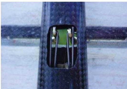
**Heiß geliebte Hebele:** Das ist seit Jahren Tradition bei allen »Fireworks«, die Anlenkung der Querruder durch den Rumpf hindurch. Nichtkenner und Ungeduldige treibt diese Fummelei schnell in den Wahnsinn. Aber keine Angst, wenn man das einmal mit der Spitzzange raushat, dauert das selbst bei Wind und Wetter auf dem Platz keine 20 Sekunden
