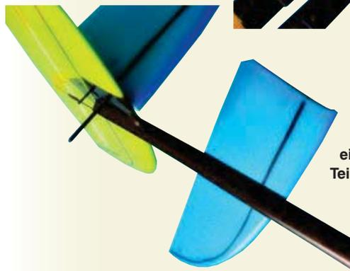
**Bunte Pendelei:** das Pendelhöhenleitwerk und die beiden Achsen im Seitenleitwerk des »Steigeisen«. Die Fertigungsqualität aller Teile ist sehr hoch
