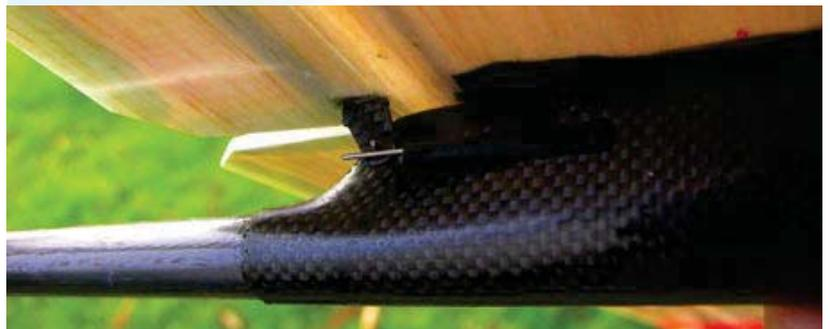
Flatterfrei: die Anlenkung der Querruder. Sehen Sie genau hin, ein Stück Draht verhindert ein mögliches Abrutschen – gut gemacht!
