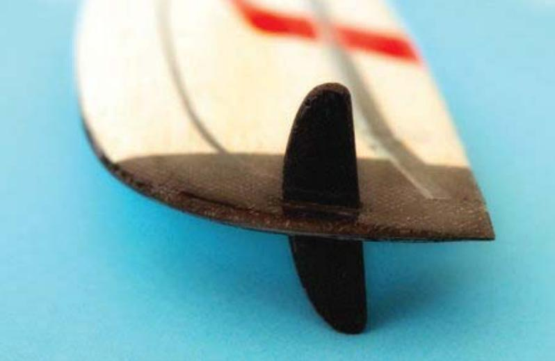
**Tipp dreizehn:** Ein stylisches, profiliertes Wurfblade in einer hochwertigen Schalenfläche. Fräsen Sie diesen Schlitz nur, wenn Sie vorher einen guten, entspannten Tag hatten! Lassen Sie sich Zeit und den Schlitz lieber eine „Schuhgröße“ zu eng. Ein halber Millimeter zu viel versaut Ihnen an dieser Stelle ganz schnell den Tag. Ausgebuffte Profis neigen das Wurfblade leicht nach vorn, so liegt es mit der Fläche beim Wurfstart noch sicherer in der Hand
