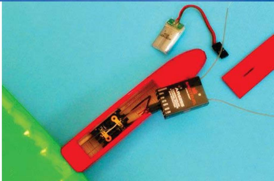
**Flugausrüstung: Zeitgemäß steuern wir den kleinen »Birdy« heute mit 2,4 GHz. Fliegen ohne Kanalstress, immer und überall. Günstiger Stromversorger ist die winzige 145er-LiPo-Zelle, das reicht für zwei bis drei Stunden. Weniger ist halt mehr!**
