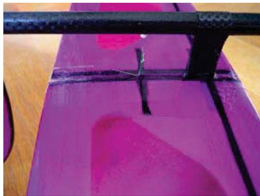
**Leicht und stabil: das zweigeteilte, unten liegende Pendel-Höhenleitwerk des »Fireworks«.** Verstärkt mit einigen Kohlerovings und einem Schuss dünnflüssigem Sekundenkleber. Ich bin ein Fan davon, nie wieder Stress mit der EWD oder dem Transport
