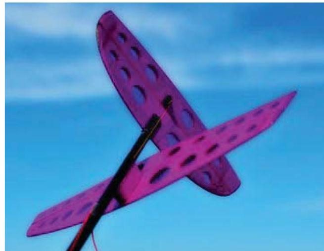
**Steuerzentrale:** Dieser »Birdy« wird nur über Höhe und Seite gesteuert. DLG-typisch mit Feder und Faden. In fast zehn Jahren ist mir noch nie so ein Anglerfaden gerissen. Dem Material können Sie vertrauen! Übrigens täuscht das Foto, das Höhenleitwerk (Grüße an Mark Drele!) liegt oben
