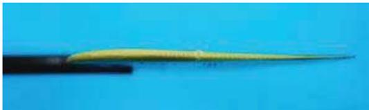
**Viel Profil:** das unübersehbar profilierte Seitenleitwerk von unten. Es reduziert beim Start das Pendeln, bringt mehr Wurfhöhe. Der Trick klappt allerdings nur bei Rechtshändern
