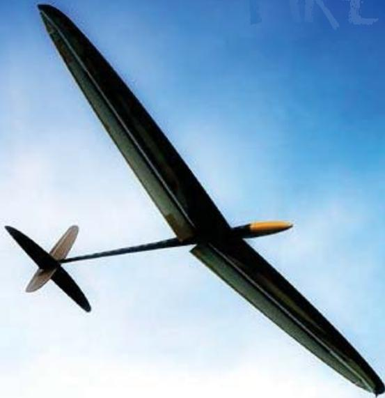
Landen den »Flow«: Nach schneller Fahrt aus dem Rückraum kommt der »Flow« mit gesetzten Klappen zur Landung rein. Hier programmieren, was mechanisch maximal geht, 45 Grad plus sollten es sein
