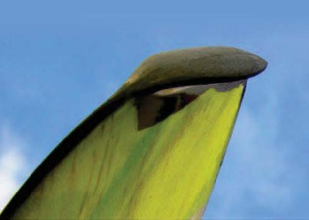
Fest im Griff: Das Wurfblade ist beim kleinen »Fireworks« fest in die Fläche mit eingearbeitet, ein geniales und edles Design. Aber nichts für Piloten mit verschwitzten Fingern
