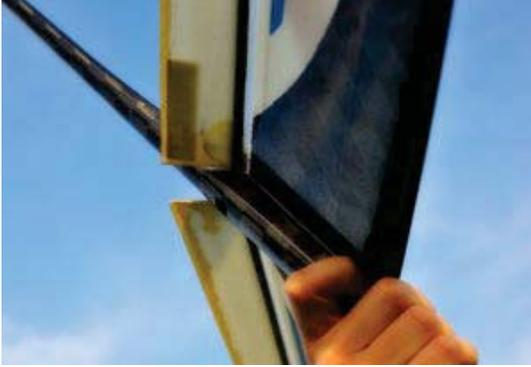
**Voll ausgebremt:** die Klappen des »Flow« bei maximaler Bremsstellung. Bitte mischen Sie ausreichend Tiefe bei, sonst gibt die Landung ein pumpendes Desaster
