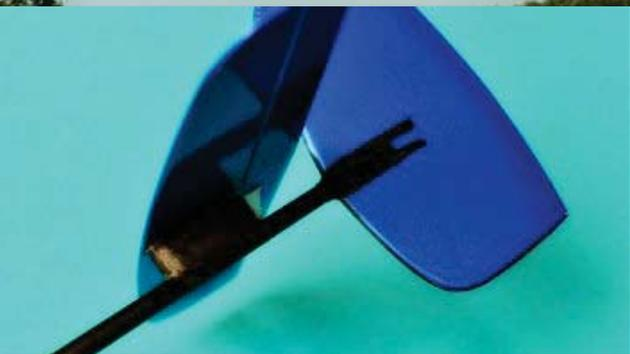
© Mark Drela: Wie jeder zweite DLG in der Szene ist auch das Leitwerk (und das Profil) des »TopSky« von der US-Ikone „inspiriert“. Eine sichere Bank, denn Drelas Ideen sind immer spitze. Das hier oben liegende Höhenleitwerk sitzt auf einem Balsapylon, der durch ein wenig Glasgewebe verstärkt ist – alles andere ist schwarzer Edding
