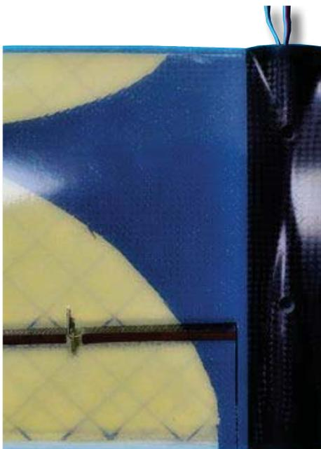
**Kein RDS, was nun?** Viele Top-Modelle können Sie wahlweise mit RDS ordern. Beim »Steigeisen« geht das leider nicht! Für Sie (oder den Bauservice von Stratair) bedeutet das, dass die Klappen diagonal mit einem Stahldraht durch die Schalenfläche hindurch mit den Servos verbunden werden. Das funktioniert natürlich gut – ist aber optisch bei Weitem nicht so elegant wie ein unsichtbares RDS. Ganz nebenbei ist es eine lästige Frickelei. Wer schneidet schon gern an einer so teuren Schalenfläche rum
