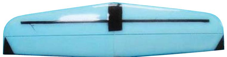
**Leicht, leichter, Leitwerk: Unter elf Gramm für ein Schaumleitwerk, das ist Rekord! Die Kevlar-Kufe unter dem Seitenleitwerk wartet geradezu auf die ersten kleinen Steinchen in der Wiese**
