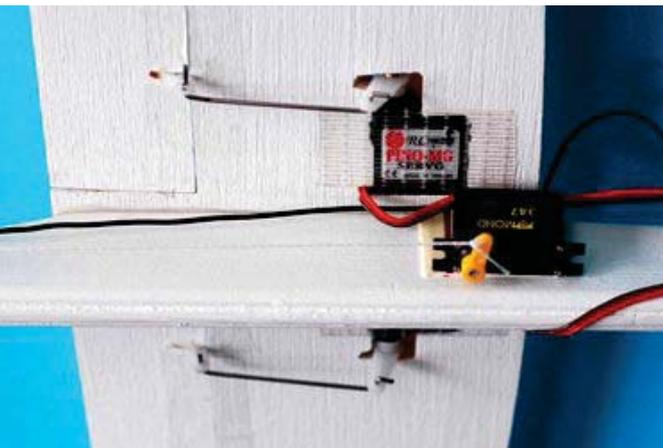
**Elektrisches Trio:** Die beiden 6-g-Servos für die Querruder verschwinden stolperfrei in der massiven Balsafläche. Das FS 31 am Höhenruder hat es nicht ganz so zugfrei: Es ist mit doppelseitigem Klebeband schnell und schmerzfrei auf die Rumpfkeule „gepappt“
