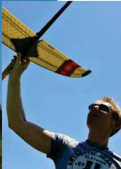
**Brems das Eisen:** Maximaler Ausschlag bei den Klappen ergibt eine brachiale Bremswirkung. Sehr schön ist hier der Aufbau der Disserfläche zu sehen
