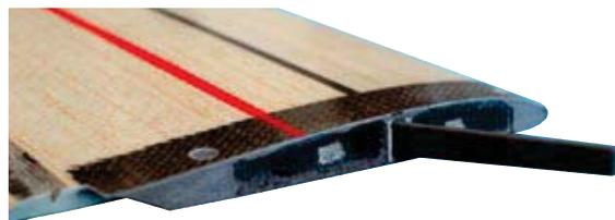
Ab durch die Mitte: das Herzstück der geteilten »extend«-Fläche. Hier ist alles dick mit Kohle verarbeitet und superstabil. Insgesamt vier Schrauben verbinden die Fläche mit dem schlanken Vollkohlerumpf. Das hält!
