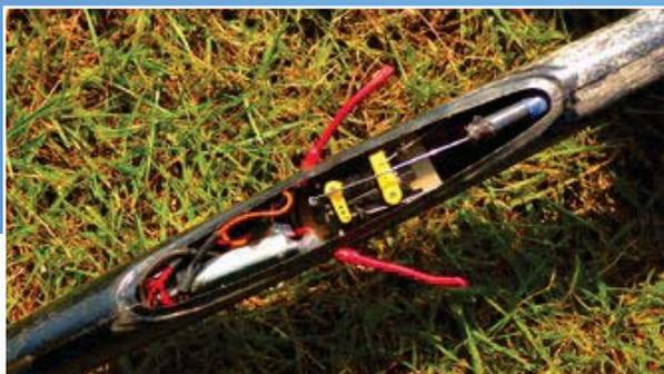
**Unfreundliche Nase:** Sie erkennen das sofort an den beiden „Fühlern“, die aerodynamisch angepasst nach hinten rausbaumeln – der Rumpf des »Stobel V3« ist komplett aus Kohle. Und somit nicht 2,4-Gigahertz-freundlich, die Antennen müssen raus. Hinter den beiden Servos erkennen Sie das Ballastrohr, mit dem wir den »Stobel« bis auf 320 Gramm aufbleien können
