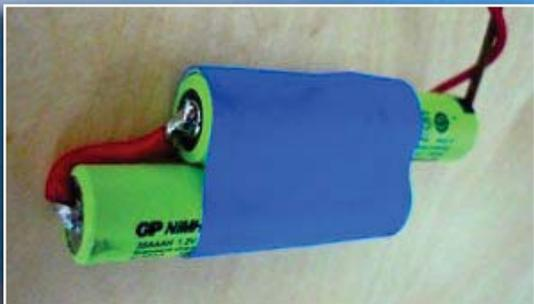
Flach gestapelt: Der Zahnstocher-Rumpf fordert seltsame Akku-Konstruktionen. Gott sei Dank verschwindet diese schräge Lötaktion unsichtbar in der langen Nase
