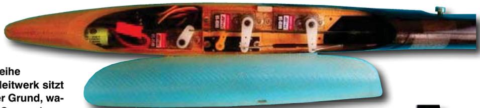
**Schnell durchschaut:** So sieht sie aus, die viel gepriesene RDS-Anlenkung in einem Profi-DLG. Hier (bitte drehen Sie das Heft auf den Kopf) ein »Salpeter«. Oben in der stabilen Tasche sitzt der abgewinkelte Hebel, die lange Stange führt zum Graupner DS 281, das unter der D-Box gut und sicher versteckt ist. Eine absolut wartungsfreie (wie auch?) und spielarme Lösung. Wenn Sie beim Kauf die Wahl haben, sollten Sie sich immer für das RDS entscheiden ▶
