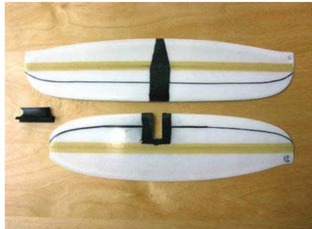
**Schicke Schale:** das hoch gestreckte »Ultegra«-Leitwerk. In der Mitte der kleine Carbon-Pylon für das Höhenleitwerk
