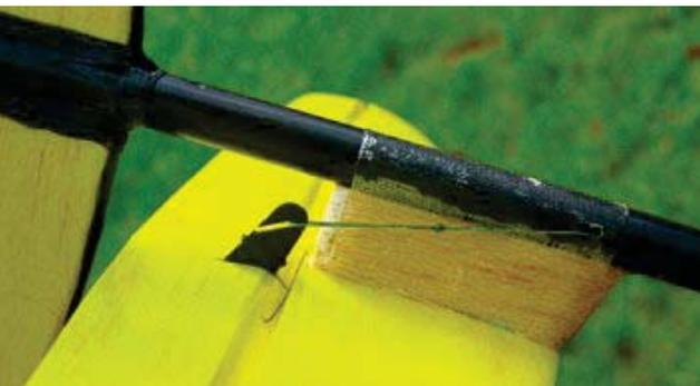
Einfach und leicht: Das Höhenleitwerk sitzt an einem Balsapylon unter dem Träger. Ein Stück 25er-Glasgewebe, getränkt mit dünnflüssigem Sekundenkleber, sichert es. Anlenkung mit Faden und Feder
